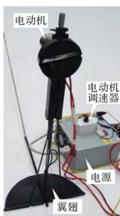
图2 实验模型及其控制系统
